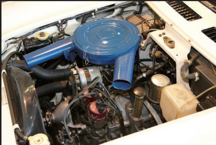
與往復式引擎相比，較小巧的轉子引擎被安裝在附屬設備下面，以便隱藏。這張照片是後期型的引擎，添加了冷卻器。
