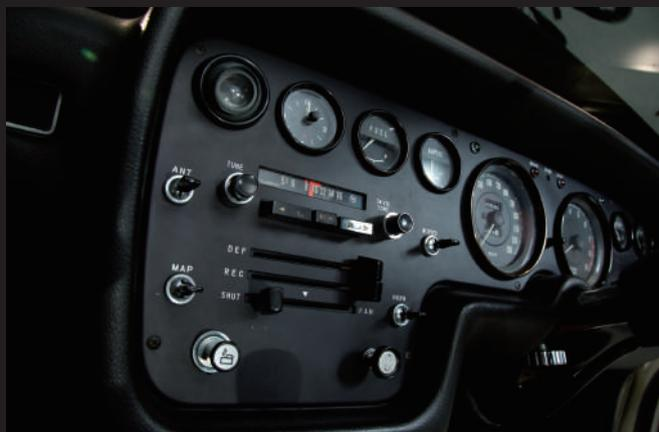
中央控制台的上部裝有收音機，下部裝有暖氣操作面板。3連儀錶盤從左到右分別為時鐘、油量計和電流錶。
