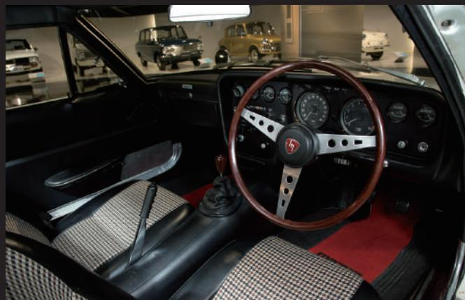
Cosmo Sports的儀錶板區域。透過操縱位於方向盤柱右側的旋鈕，可以調整方向盤的前後位置。
